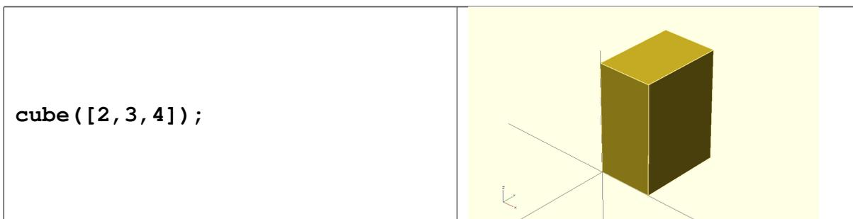
einen Quader mit den Seitenlängen  $x = 2, y = 3, z = 4$ .
