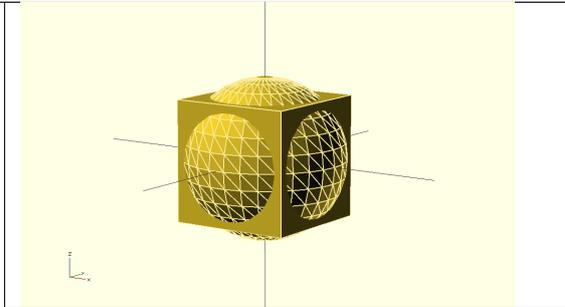
In diesem Beispiel hat die Kugel den **Radius 40** und der zentrierte Würfel die **Seitenlänge 60**. Das gleiche Bild entsteht, wenn bei der Kugel der **Durchmesser 80** angegeben wird: **sphere (d=80) ;** .
